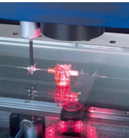
Präzise: Der optische Sensor der O-INSPECT ist vor allem für die Kontrolle kleiner, komplexer Teile geeignet.
