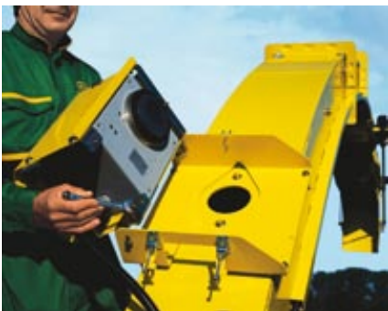
Ernten mit Carl Zeiss: Das HarvestLab-System misst mit einem Nahinfrarotsensor von Carl Zeiss das Erntegut einmal pro Sekunde. Das ermöglicht die qualitätsbezogene Abrechnung der Landwirte mit ihren Abnehmern.
